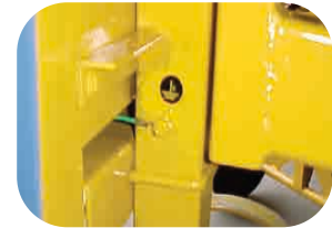
Punto de descarga a tierra existente en la mezcladora.
